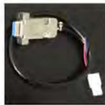
Cable RS232 4 pines a RS232 a DB9 enlaza RS232 del IC6 a convertidor
