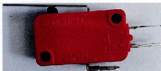
Figura 77. Detalle componente Microswitch (Interruptor de puertas), RV-162-1C25 sin revisión, marca RENEW, vista posterior.
