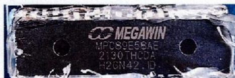
Figura 6. Detalle del microcontrolador MPC 89E58AE ubicado en IC3 de la tarjeta CPU que contiene el programa principal.
