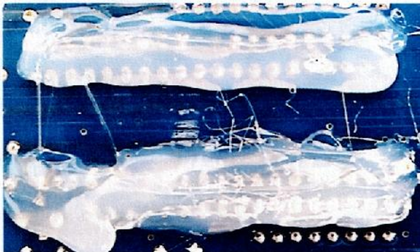
Figura 13. Detalle de soldadura con resina epóxica transparente del microcontrolador ubicado en IC6 de la tarjeta CPU identificada como U201-B revisión 001. Ver detalles en rectángulo rojo.
