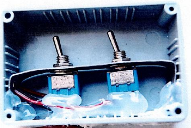
Figura 67. Componente Microswitch (Interruptor de pistolas), CZ7141 sin revisión, marca CNTD, vista frontal. Ver detalles en rectángulos rojos.
