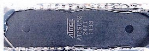
Figura 7. Detalle del microcontrolador AT89C52 ubicado en IC6 de la tarjeta CPU utilizado para el manejo de display.
