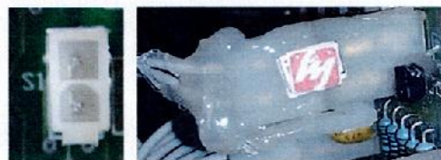
Figura 18. Detalle del conector identificado como S1 de la tarjeta Panel de control (Membrana de digitado) utilizado para interconexión con el Switch de calibración.
