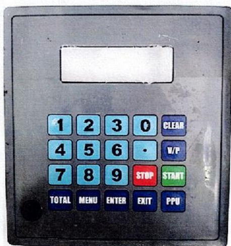
Figura 19. Tarjeta Panel de control (Membrana de digitado) identificada como U204-B revisión 001. Vista frontal.
