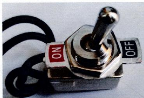
Figura 60. Detalle componente Switch de calibración, sin identificación y sin revisión, vista superior.
