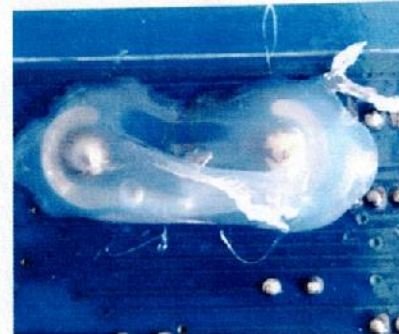
Figura 14. Detalle de soldaduras con resina epóxica transparente del capacitor de la tarjeta CPU identificada como U201-B revisión 001.
