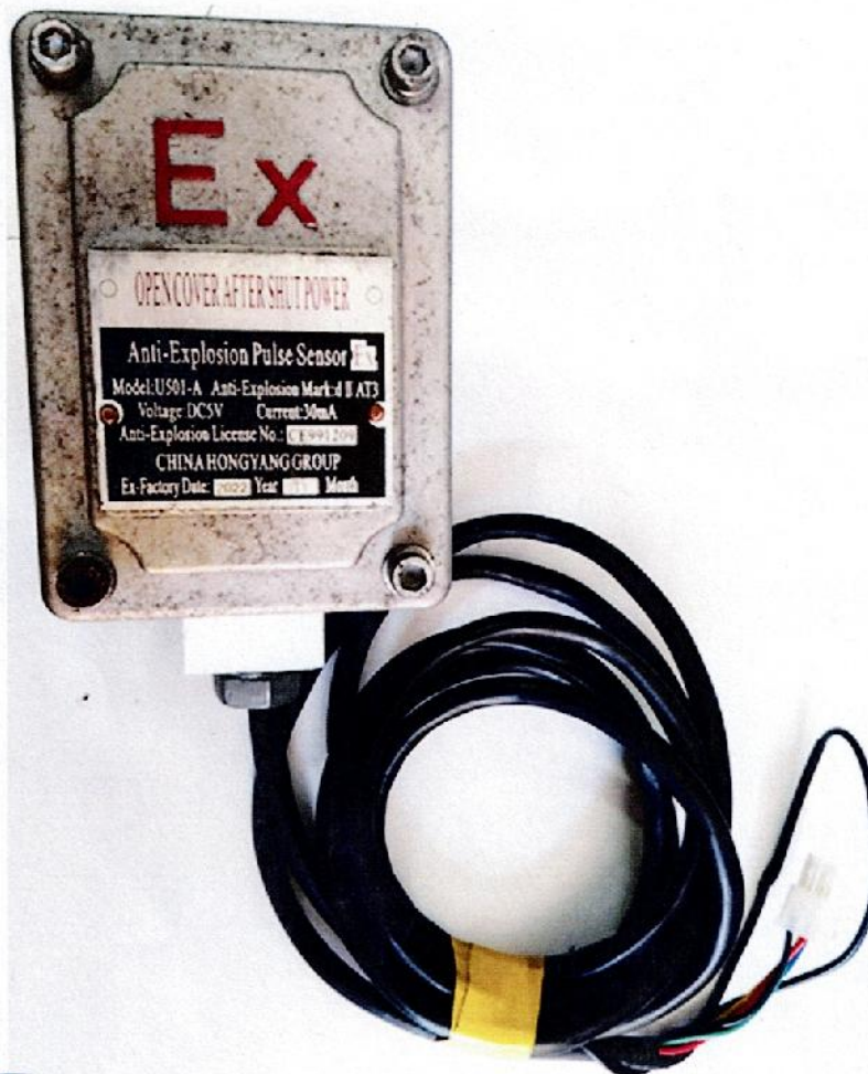
Figura 46. Ensamble de Pulsador identificado como U501-A revisión 001, incluye carcasa de metal para medidores de Bajo y Alto flujo. Vista frontal.
