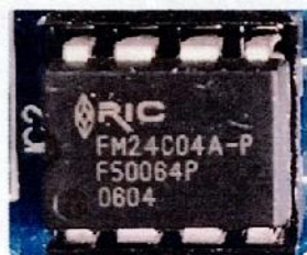
Figura 5. Detalle De la memoria FRAM FM24C04A ubicado en IC2 de la tarjeta CPU utilizada para guardar los totalizadores.
