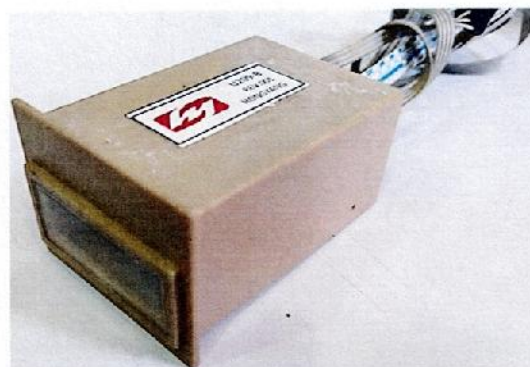
Figura 56. Componente Totalizador electrónico LCD identificado como U209-B revisión 001 vista frontal.
