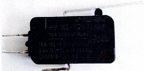
Figura 76. Detalle componente Microswitch (Interruptor de puertas), RV-162-1C25 sin revisión, marca RENEW, vista frontal.
