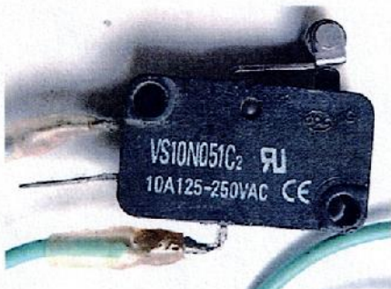
Figura 74. Detalle componente Microswitch (Interruptor de puertas), VS10N051C2 sin revisión, marca HIGHLY, vista frontal.
