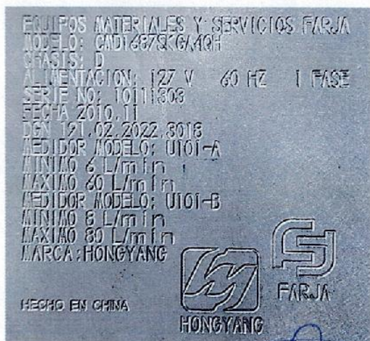
Figura 3. Detalle de la Placa de identificación del Sistema de medición y Despacho de Combustibles probado.
