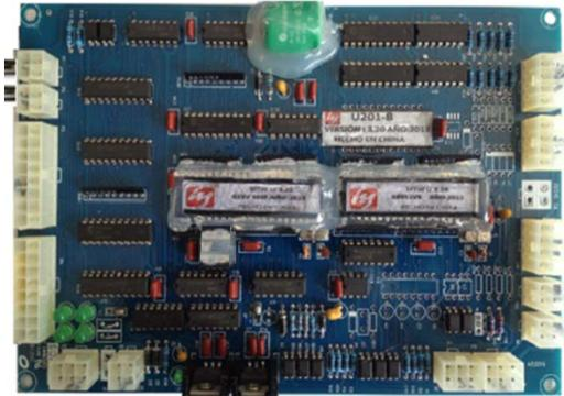
Esta unidad también conocida como tarjeta principal o CPU, es en donde se procesan todas las funciones de cálculo y control. Esta tarjeta cuenta con conectores que reciben el arnés evitando errores que puedan dañar al equipo si va a cambiar la tarjeta asegúrese de marcar con números los conectores. Según corresponda.
